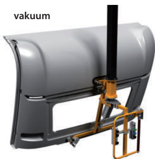
Vakuumtraverse für die Bugwand LVA 66.01A
