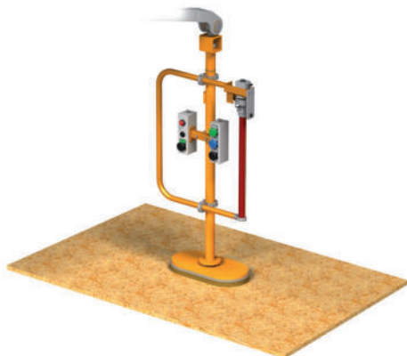
Vakuum-Flächensauger für Spanplatten Konzeptbild
