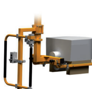
Gabelwerkzeug mit verstellbaren Greifbacken für verschiedene Toilettenschüsseln LHA 22.21A
