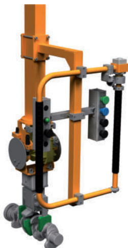
Scherenspanner mit 90° Schwenkvorrichtung für Kurbelwellen LSP 16.04A
