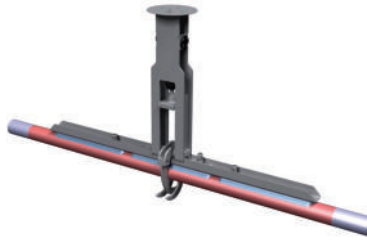
Vakuumtraverse mit Hakenunterstützung für Wellen LVA 59.03A
