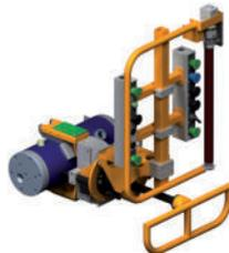
Parallelspanner mit manueller 90° Drehvorrichtung für Ölabscheider
