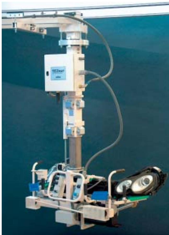
Pneumatisches Greifwerkzeug mit integrierter Zentrier-einrichtung für die Montage von PKW-Frontends mit einem Lastgewicht von 35 kg.
