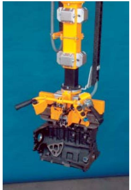
Pneumatisches Greifwerkzeug für die Handhabung von Motorblöcken an Bearbeitungsmaschinen mit einem Lastgewicht von 48 kg.
