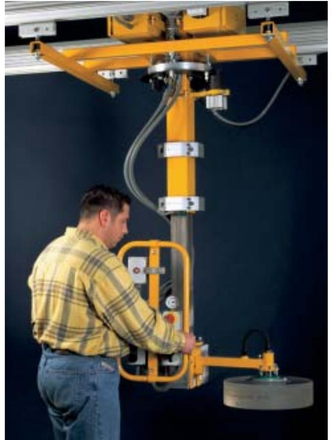
Vakuumgreifer für die Handhabung von Präzisions-
