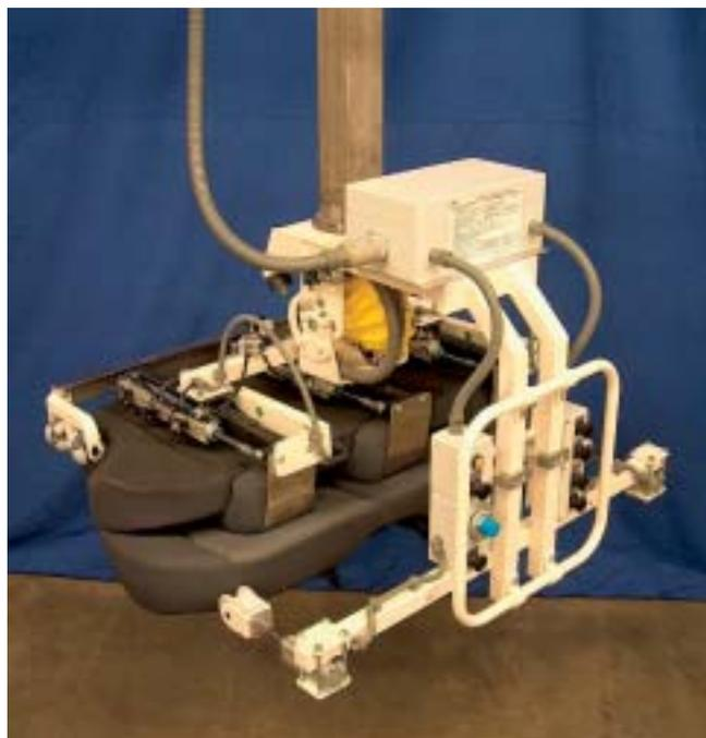
Pneumatisches Greifwerkzeug für die Handhabung von geteilten PKW-Rücksitzbänken mit einem Lastgewicht von 45 kg.
