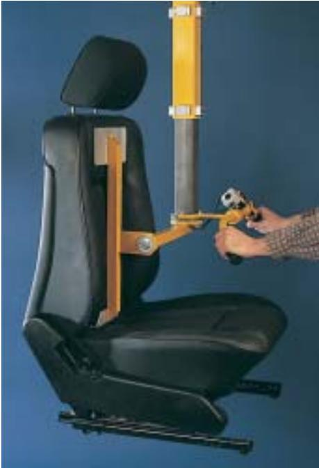
Mechanisches oder pneumatisches Werkzeug für Sitzmontage mit einem Lastgewicht von 15 - 28 kg.
